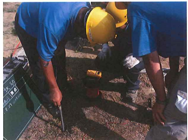
浦安市での液状化地下水水位調査例
