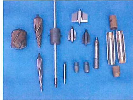
各種ドリル・サンプル器具・ロッドの例 各メーカーの器具用ジョイント製作可 ロッド径Φ19（標準） Φ25穴付等 本機は50cm毎の貫入です
